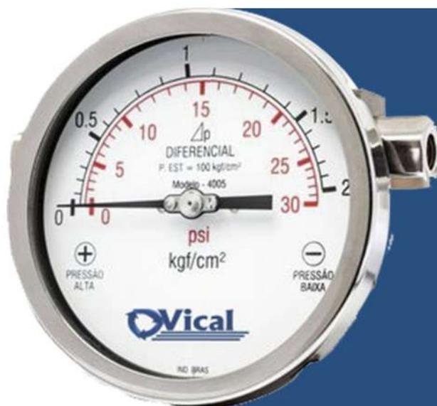
Corpo construído em alumínio com sensor magnético, utilizado para monitoramento de pressão diferencial de filtros, vazão de processos em geral, nível de tanques com alto diferencial e processos gasosos. Projetados para suportar pressões estáticas de até 200 bar e devido sua construção, torna-o um instrumento com excelente relação custo/benefício.
