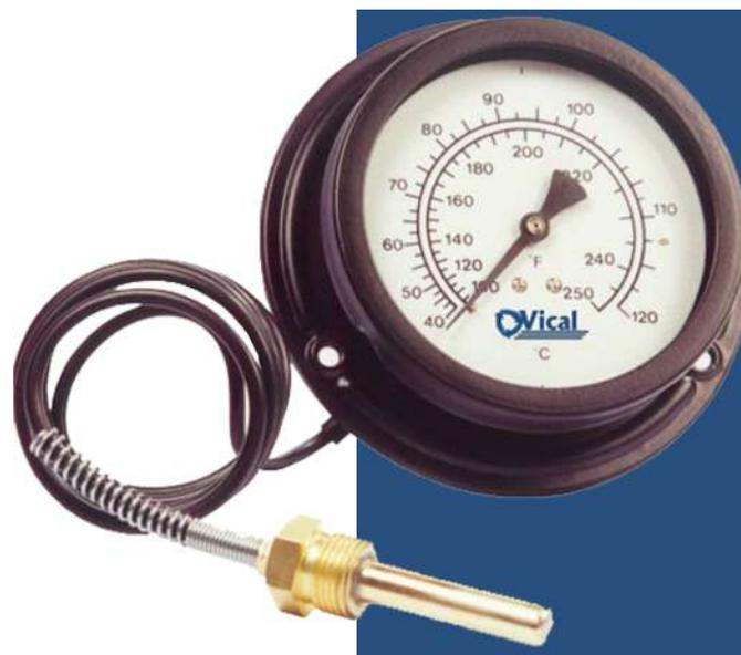
Instrumentos mecânicos para controle de temperatura em pontos remotos ao local do instrumento. O sistema de medição é feito através da variação da pressão, devido as oscilações de temperatura do fluido que se desloca entre o bulbo sensor e/ou bourdon.
