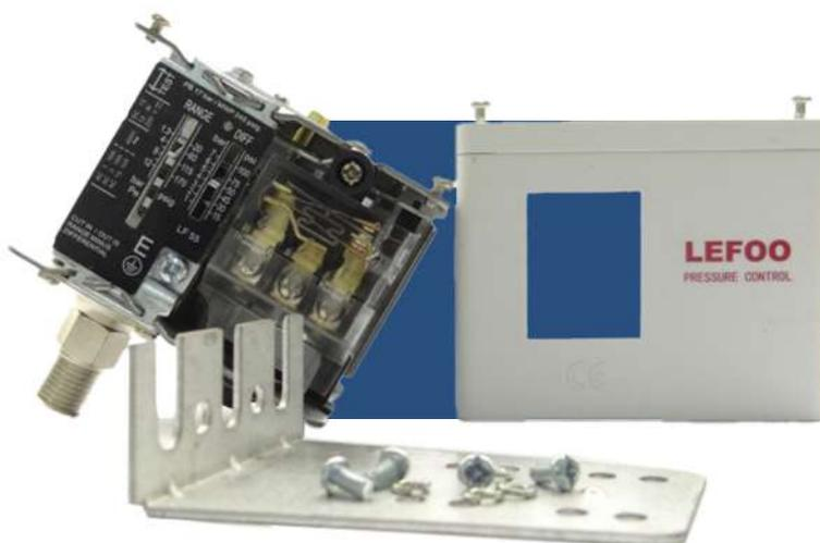
A série de Pressostato LF55 é utilizado com fluidos de refrigeração, ar e água (até 120 °C). Extremamente flexível, com diferencial ajustável, variando em função do modelo, podendo chegar a 33 bar. Utilizado em diferentes aplicações, comerciais e industriais, ao redor de todo o mundo, conta com grau de proteção IP44.
