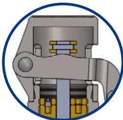
Capô dotado de furo roscado, para a realização de teste hidrostático, sem retirada da válvula do equipamento.
