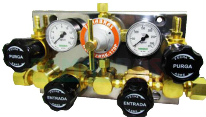
Para dois ou mais cilindros simultaneamente conectados, sempre um lado em funcionamento e outro de reserva. Aplicado em sistemas onde não possa ocorrer a interrupção do processo na substituição dos cilindros. Possui registros para purga, evitando assim, contaminação dos gases na troca dos cilindros. **Uso Industrial, Soldagem, Corte e Aquecimento**
